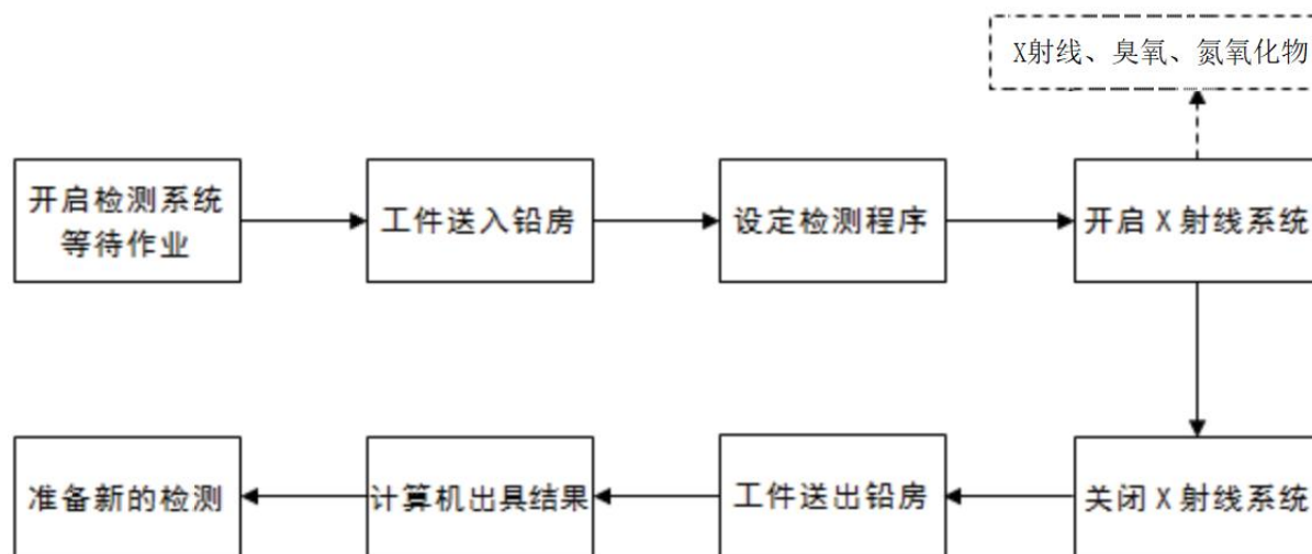
图 5.7 X 射线检测仪的生产工艺流程及产污环节示意图
